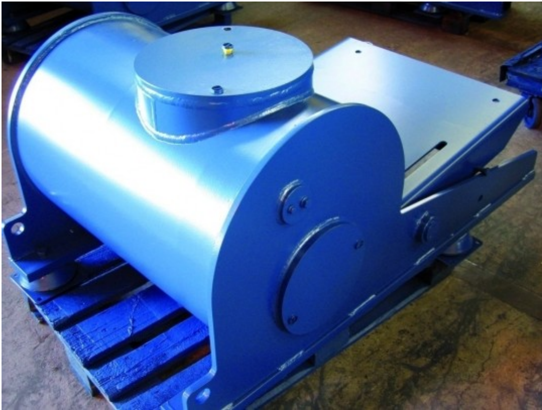
Bild 2: Die neue Fertigung von Schalldämpfern für Drehkolbengebläse-Aggregate „Delta Blower“ trägt der stark gestiegenen Nachfrage nach diesen Industrieanlagen Rechnung. Bild: Emmerthaler Apparatebau
